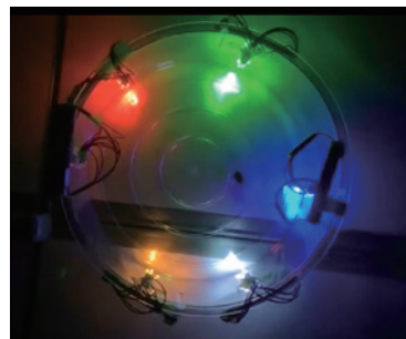
▲プラスチック容器を上から見た図。各LEDは72°間隔、底面から5cmの高さに設置する。
