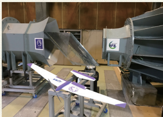
▲風洞実験の装置と火星飛行機の模型
