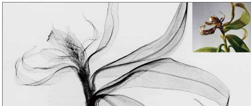
▲ SOIPIX センサーを用いて撮影した植物のX線画像
