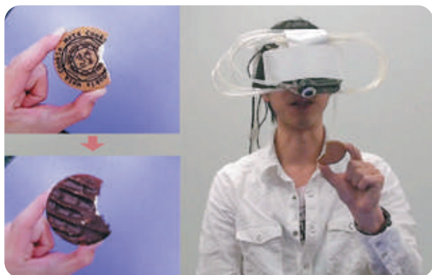
(図1) 視覚と嗅覚の提示により味の感じ方を変えるメタクッキー
