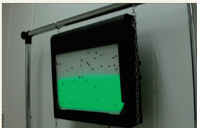
▲弘中さんが企業と開発した捕虫装置。紫外線(上), 緑色光(下)が出ており、エッジを形成。従来品の1.2～3.5倍(昆虫種によって異なる)の捕虫性能を実現した。
