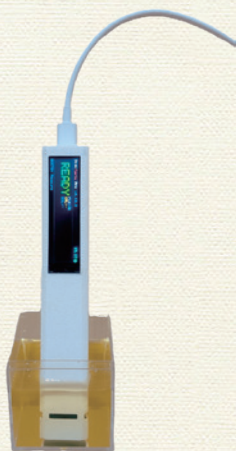
▲液体の複合的な「状態」を測定し、味再現や異常検知に使うセンサー
