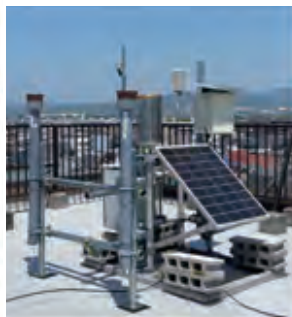
自動排水機能付き貯水槽雨量計の構造と実証実験の様子
