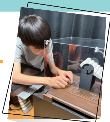
自作の抗力実験装置を使い、波型翼に発生する抗力を測定する藤田さん。
