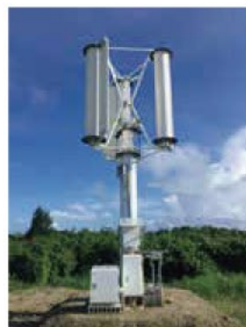
沖縄に設置された垂直軸型 マグナス風力発電機の試作機
