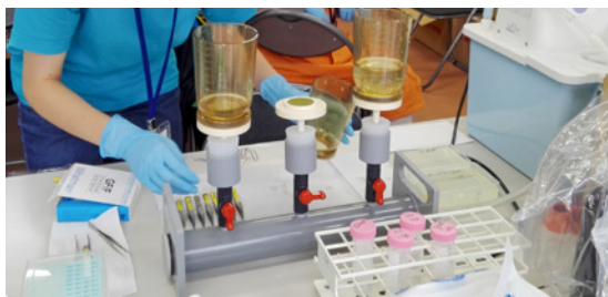
水中に漏れ出た DNA を濃縮し、解析する
