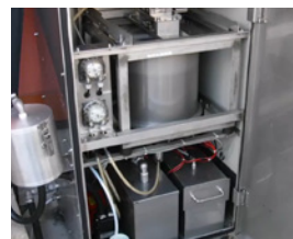
同社が開発した 遠心式高性能固液分離装置
