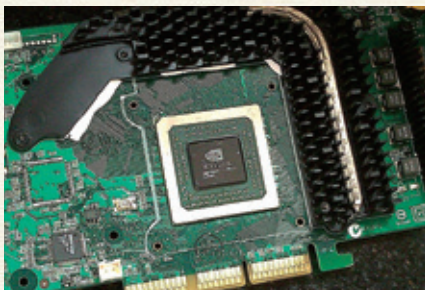
▲ PC内部にあるLSIの外観(このチップの中に数十億個のトランジスタが入っている)。
