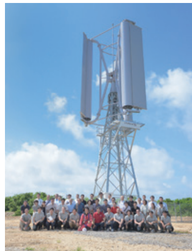
▲2018年8月3日、沖縄県石垣島で10kW量産型発電機の実証試験が開始。高さ約20mの発電機。中央前列の赤い上下の作業着が渡邊さん。
