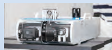
海底地形の凹凸を自動追従するAUV試作機
