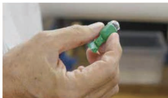
全消化管の内視検査を実現する自走カプセル内視鏡 (愛称: ミニマーメイド)
