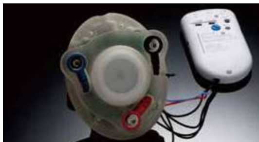
▲ 製品化に向けて改良が加えられている超聴診器の試作
