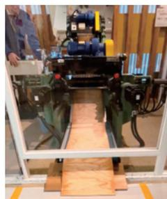
▲ロータリーベニヤレースで丸太を剥き、合板に使う薄い板（ベニヤ）を生産している様子。
