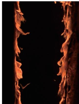
▲プラスチック燃料が高圧下で燃える様子は、専用の窓からハイスピードカメラで撮影する。(千葉工業大学宇宙輸送工学研究室在籍時に撮影。)
