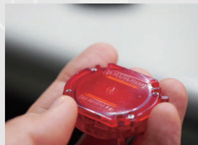
中にハーフインチウェハ1枚を収納することができるMinimal Shuttle。Minimal装置間の移動に使用する。
