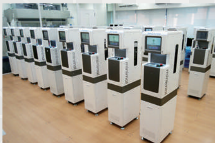
一般社団法人ミナルファブ推進機構所有のMinimal Fab。構成するMinimal装置の1台1台が異なる製造プロセスを担う。
