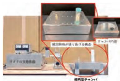
楕円型のチャンバを活用して、マイクロ波を効率的に集中させるマイクロ波加熱装置を開発する。反射波によるロスがほとんどなく、様々な被加熱物に対応可能な本技術で、あらゆる加熱の課題解決を目指す。
