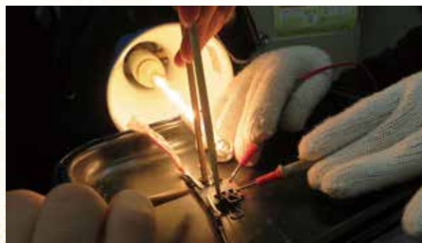
色素増感太陽電池に光をあてながら高温における電力を測定している様子
