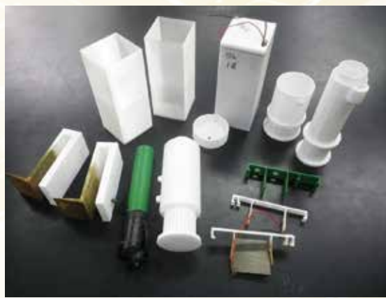
3Dプリンタで自作した電極の設置に必要な部品
