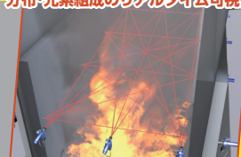
製造プロセス内の温度やガス濃度 分布・元素組成のリアルタイム可視化
