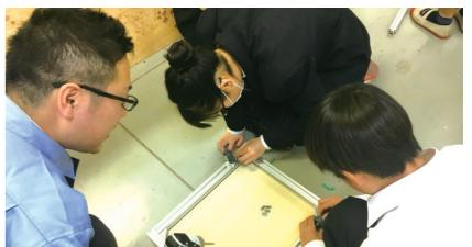
ねじ穴をあける必要のない「アルミフレーム」を使用することで、短時間で何度も試作を繰り返すことができます。
